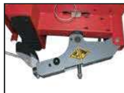
Brazo especial ajustable para ruedas de grandes dimensiones.
