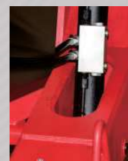
Cilindro hidráulico equipado con válvula de seguridad anti retorno.
