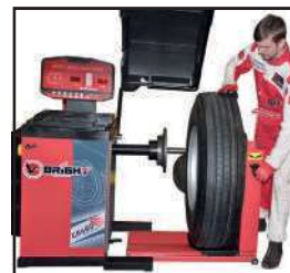
Elevador neumático para facilitar el manejo de neumáticos industriales.
