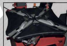
Plato giratorio de 4 centradores automáticos conos cilindros neumáticos; con cubierta protectora.
